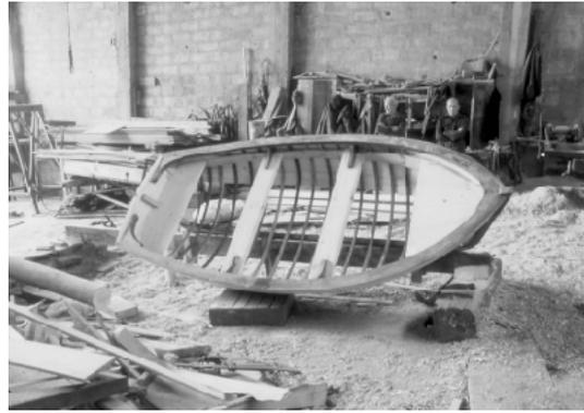
El proceso continúa con la introducción del resto de las cuadernas para finalizar retirando las guías, procediendo por último con el aforrado del resto del casco.
