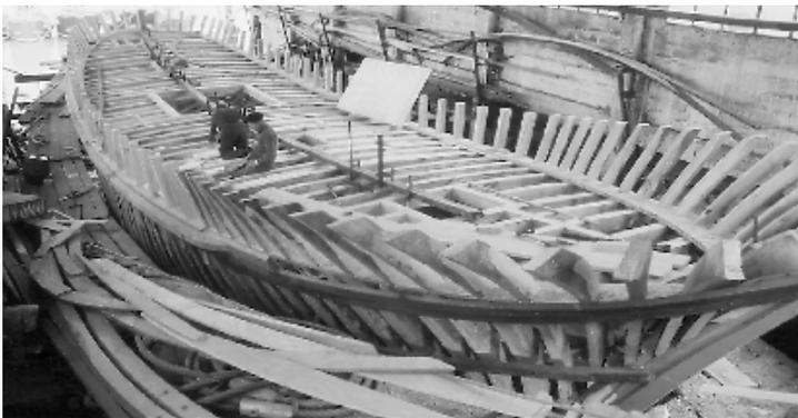
En las embarcaciones de pequeño y mediano tamaño ambos tipos de estructura se empleaban indistintamente, sin embargo, alcanzadas ya ciertas magnitudes únicamente se utilizaba la cuaderna aserrada por la mayor solidez que ésta ofrecía.
