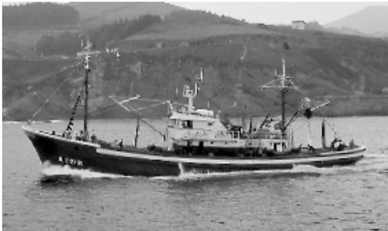
*El Izar Alde es la mayor embarcación de superficie construida en el País Vasco. Fue botada en 1978 en el Astillero Muruaga de Bermeo siendo realizado el montaje por Construcciones Echebarria también en Bermeo. Entre las características de la embarcación, incluidas en cuadro anexo, podemos destacar como dato anecdótico que en su construcción se emplearon más de 9.000 horas de trabajo.*
