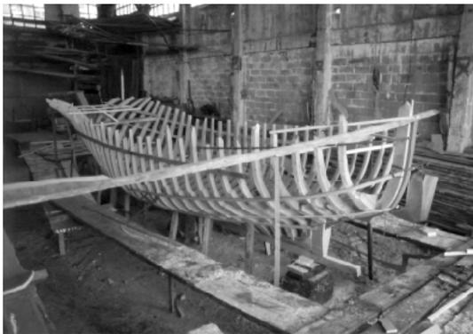
En la técnica de la cuaderna aserrada la construcción se realiza a partir de un sólido armazón al que posteriormente se le coloca el forro, es decir, es el forro el que adopta las formas del bastidor. La construcción se inicia con la colocación de la roda, el codaste y la quilla de forma análoga a la anterior, pero en este caso sobre la quilla se van arbolando directamente las cuadernas, componiendo así el esqueleto de la embarcación.
